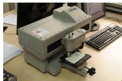
赠与的雕刻机。像打印机一样连接到电脑上使用。
