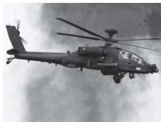
AH - 64D Apache Velocidad máxima: 365 km/h.
