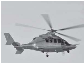
Eurocopter X3 Velocidad máxima: 472 km/h.
