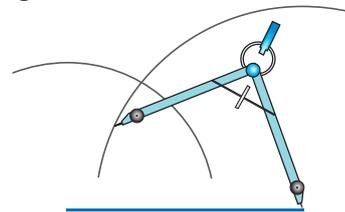
5. Traza los segmentos que van desde el punto donde se cortan los arcos de circunferencia hacia cada uno de los extremos del segmento de 8 cm. Mide los lados del triángulo para verificar que, en efecto, miden 5, 7 y 8 centímetros.
