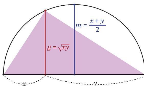
Esquema geométrico de la demostración de la desigualdad entre la media aritmética y la geométrica.
