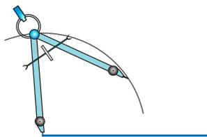
4. Repite el proceso de los numerales 2 y 3, ahora tomando la medida de 7 cm y colocando el compás en el otro extremo del segmento.
