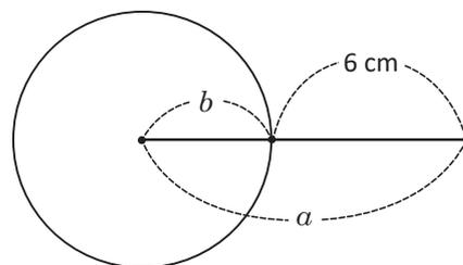
El valor de  $c$  también debe ser menor que  $a + b = 14$  cm; esto resulta de colocar el tercer vértice sobre la prolongación del segmento de longitud  $a$  como lo muestra la figura de la derecha y no se formaría un triángulo.
