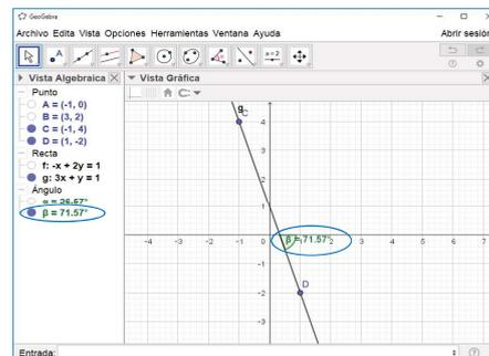
Observa que GeoGebra devuelve el ángulo medido desde la recta  $3x + y - 1 = 0$  hacia el eje positivo  $x$ . Entonces el ángulo de inclinación de la recta será igual a la diferencia de  $180^\circ$  menos el obtenido con el comando.
