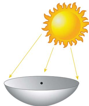
5. Un plato receptor de sonido, que se emplea en eventos sobre la equidad de género, está construido en forma parabólica con su foco a 12 cm del vértice, si en uno de estos eventos se dañó el plato y en los repuestos tienen de todas alturas pero de anchura solo hay de 8 cm, ¿de qué altura debe ser el recipiente parabólico para que el plato receptor de sonido funcione idóneamente?
