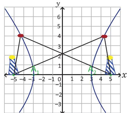
El sistema de navegación ruso CHAYKA y el sistema LORAN utilizan este principio para la localización de navíos, sin embargo poco a poco este tipo de sistemas está siendo reemplazado por la localización GPS.
