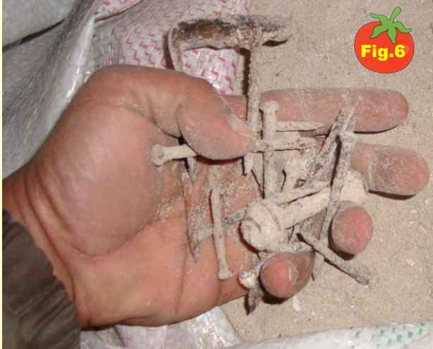
Fig.6 Prueba de oxidación con clavo
