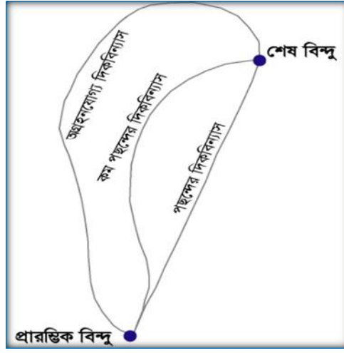
চিত্র ৩-৬ : একটি নতুন সড়কের গতিপথ নির্ধারণ
