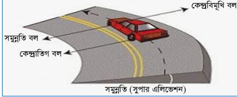
চিত্র ৩-১০ : সুপার এলিভেশন
