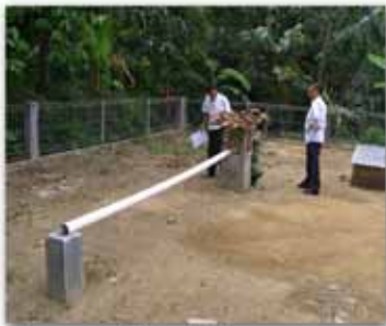
Pengamatan alat pergeseran retakan tanah
