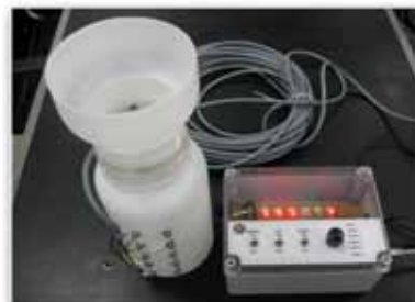
Pembuatan sistem peringatan curah hujan dan alat peringatan level ketinggian air sungai
