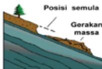
Flow (aliran) : Kekentalan dari cairan seperti gerakan runtuhan
