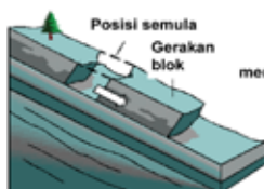
Slide (luncuran) : gerakan sejajar ke arah yang lemah dan kadang - kadang searah lereng
