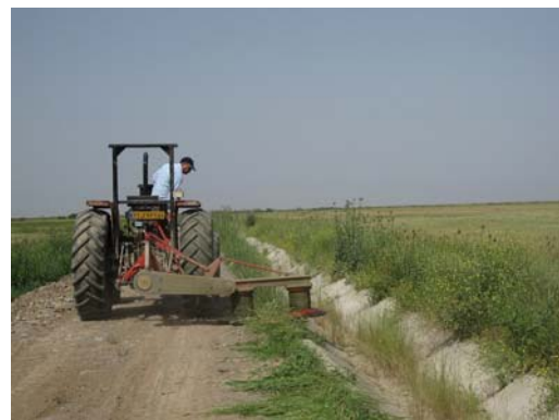
علف کنی با استفاده از دستگاه علف کن (پشت تراکتوری)
