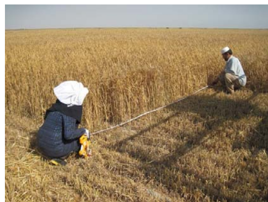
اندازه گیری عرض مسیر برداشت شده توسط کمباین
