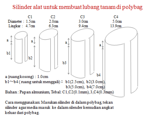
Foto26: Membuat lubang dengan menggunakan silinder.
