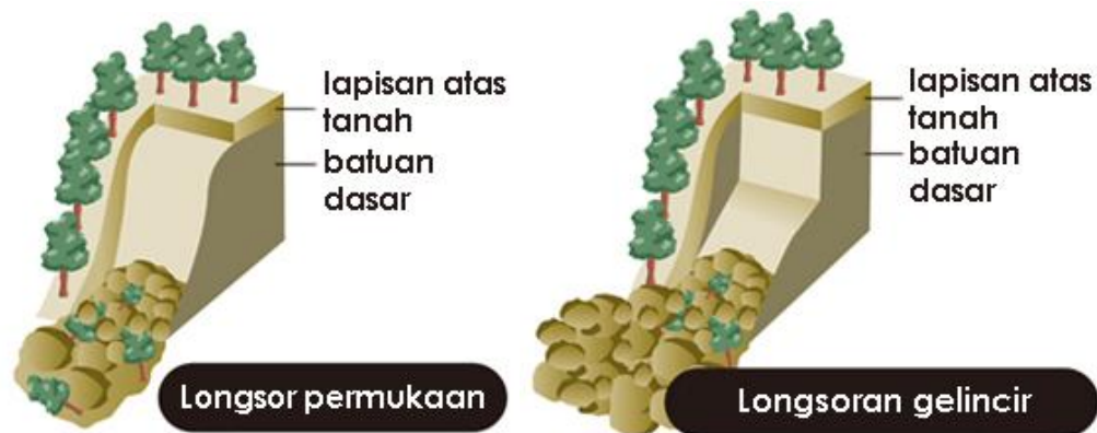
Gambar D.1 – Perbedaan antara longsor permukaan dan longsoran gelincir
