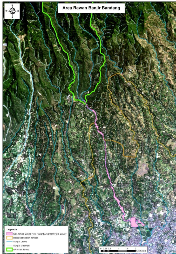
Gambar B.24 - Contoh peta area rawan banjir bandang pada DAS Kali Jompo setelah diperbarui menggunakan data hasil survei lapangan
