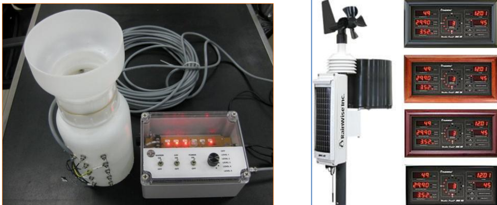
Gambar G. 4 – Komponen alat pengukur curah hujan elektronik dan digital
