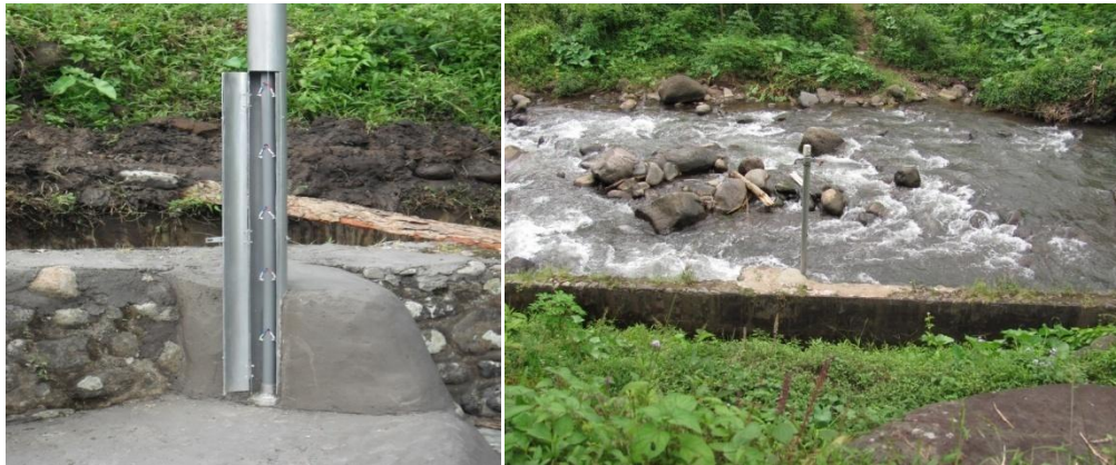
Gambar G. 5 – Contoh alat pengukur level ketinggian air
