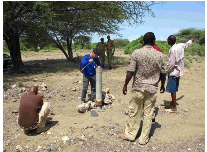
水源施設における水位水質の事前調査（トゥルカナ県） 水質が悪い為に使用されていないボーリング孔。 この井戸は連続水位計測用データロガーが設置可能。
