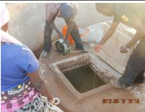
地下水水位および水質にかかる水源モニタリング調査 第1回の一斉水位観測&水質サンプリング調査を対象2県の計60カ所の既存井戸で実施しました。写真は水位計測の様子。
