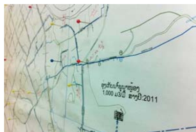
地図上に虫ピン(まち針)でマーキングされた漏水(修繕)箇所
