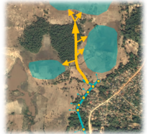
水路延伸(黄色部分)により灌漑エリアが拡大
