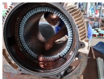
コイル取り付け(重要な作業)
