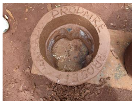
Foyer amélioré (Kamado) vulgarisé par le PRODAIRE dont la technique de fabrication est simple et réalisable seulement avec des matériaux disponibles localement.
