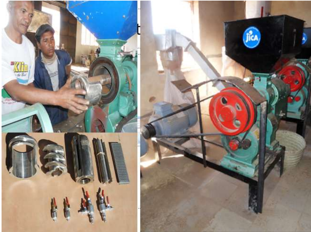
Figure 27. Penggantian komponen penyosoh beras dengan bahan stainless steel
