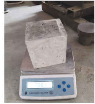
कंक्रीटको क्षमता परिक्षणका लागि तयार गरिएका नमुना
