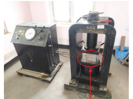
कंक्रीटको क्षमता परिक्षणका लागि तयार गरिएका नमुना
