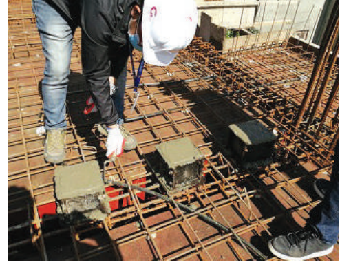
कंक्रीटको क्षमता परिक्षणका लागि निर्माण स्थलमा नमुना लिदै
