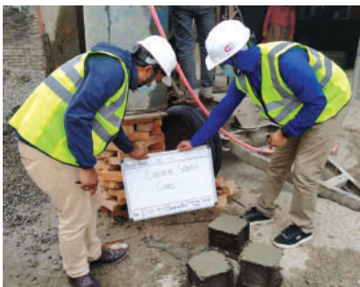
कंक्रीटको क्षमता परिक्षणको लागि नमूना संकलन गर्दै
