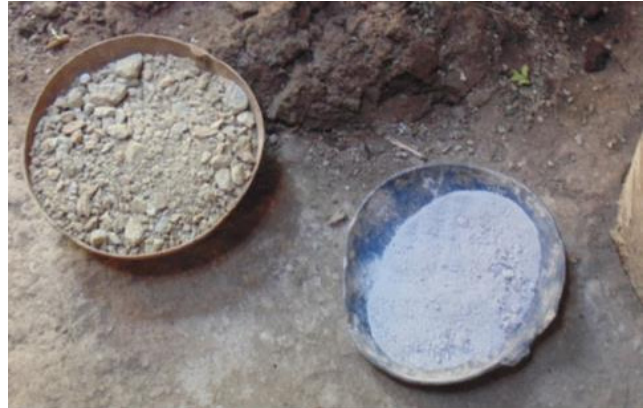
Material selecto (izquierdo) y ceniza de fogón (derecho). Cuando el material selecto tiene la ceniza volcánica tan fina como la de fogón, es buen material.
