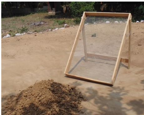
Zaranda grande de malla metálica de (1/4") para colar tierra.
