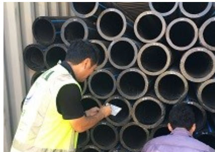
調達されたPE管の検測を技術部職員と実施
