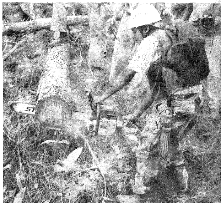
Figura 6-10. Corte y Troceo con motosierra. Proyecto CEMARE.
