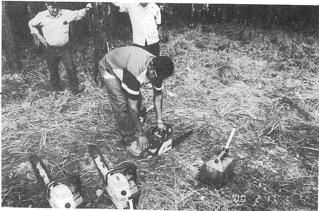
Figura 6-25. Manera más segura de arrancar la motosierra. Observe que mantiene firme la máquina con el pie.
