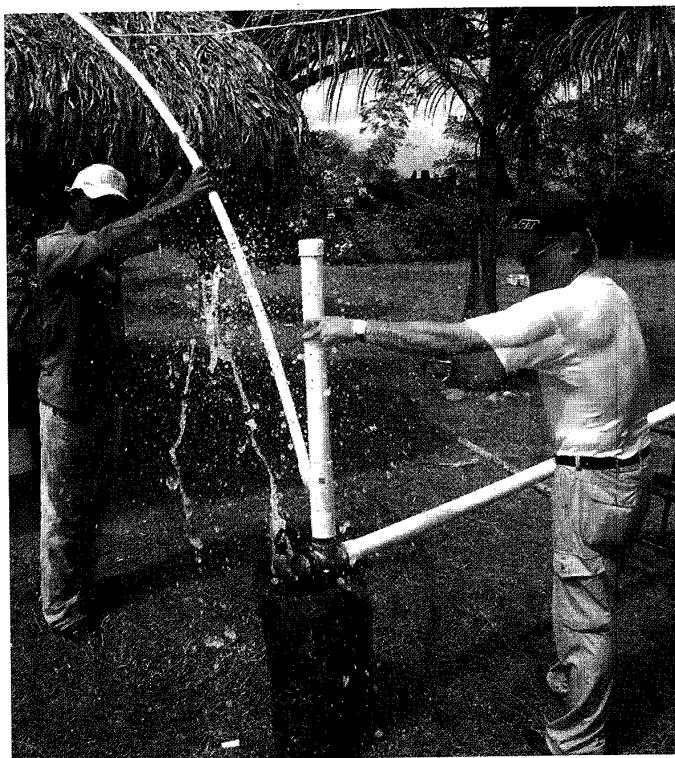
Dr Hai Sakurai, experto de corto plazo y el Sr. Samuel Avila, colaborador del proyecto, poniendo a funcionar una Bomba Ariete tipo resorte
