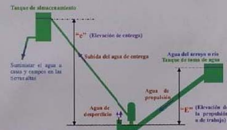
Figura - 2. Bomba Ariete Tipo Resorte
