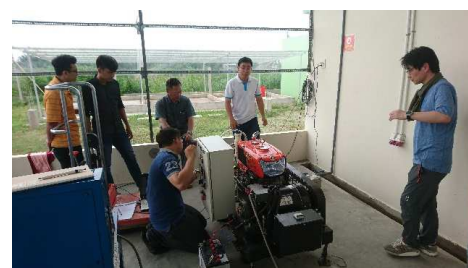
↑ バイオガスエンジン発電機のテスト運転の様子。
