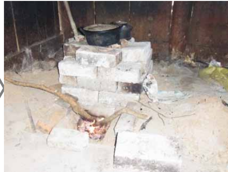
Một bếp tên lửa mới được lắp đặt
