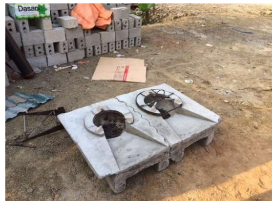
Ảnh 10: BĐCT của dự án với khuôn bếp, có thể chia làm 2 bếp đơn. 2 cửa lấy gió rộng hơn và củi đặt ở trên, không có mở lỗ ở giữa, ghi sắt có thể không bền bởi không gian mở phía trước.
