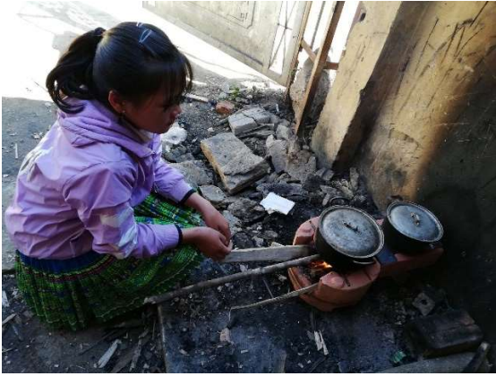
Ảnh 5: Bếp cải tiến đôi sản xuất tại Vĩnh Phúc, di động, nhỏ, cung cấp cho trường nội trú
