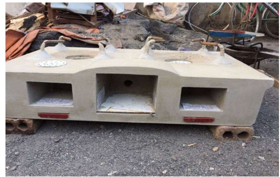
Ảnh 12: BĐCT có sẵn tại xã Mùong Giôn (sản xuất tại trung tâm huyện Quỳnh Nhai). Được làm bằng xi măng, có cửa gió lớn ở giữa, có thể sử dụng quạt điện nhỏ lấy không khí cho 2 nồi. Có 2 cửa chỉnh gió phía dưới.
