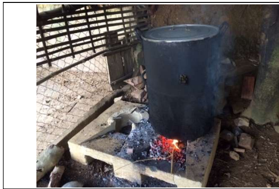
Ảnh 11: BĐCT của dự án đang sử dụng nồi cỡ to (nấu ăn cho gia súc). Bếp được đặt trên nền đất
