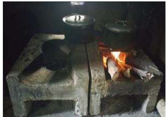
Ảnh 14: BĐCT được làm bởi một dân làng từ việc lấy cảm hứng từ bếp dự án SNRM. Thiết kế tương tự. Bên trái là cho một chảo nhỏ hơn và bên phải là cho một chảo lớn hơn với thiết kế thẳng.
