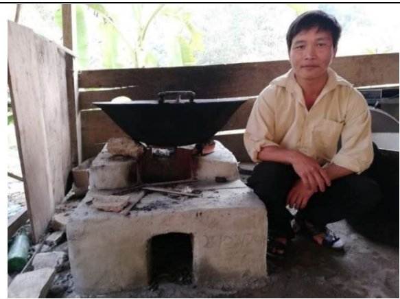
Ảnh 16: BÐCT kích thước lớn hơn với lõi đất sét chịu lửa được làm bởi người Mông, củi được đặt ở phía trên, cửa lấy gió phía dưới, nấu với chảo to
