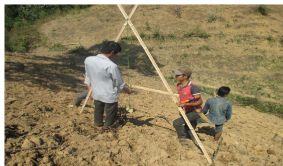
Ảnh 34: Học viên tự thực hành xác định đường đồng mức bằng thước chữ A
