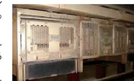
インバーターで変換された電力が他車両に送られる
