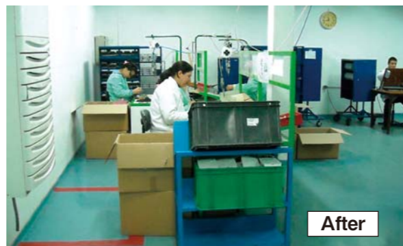
生産性が138%アップしたSIAME社の電力計の組み立てライン。学校の教室のようなレイアウトの「バッチ生産」(上)を「1個流し生産」(下)に変更し、半分程度のスペースで済むようになった
