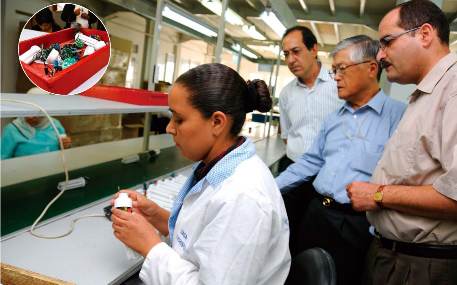
SIAME社で数日前から稼働した省エネランプの組み立てライン。女性たちが一つ一つ手作業で部品を取り付けていく。赤い箱に入っているのが不良品。その数の多さに池田克登志・JICA専門家は「不良品を作ること自体がムダ。作業を始める前に4M+1Iをチェックすべき」と指摘する。4Mとは、材料(Material)、作業員(Man)、方法(Method)、機械(Machine)、1Iとは生産情報(Information)
