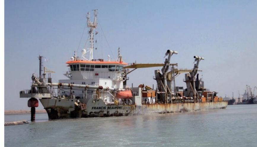
浚渫作業の様子。円借款を通じ、昨年11月までに約520万㎡の土砂の除去が完了している
