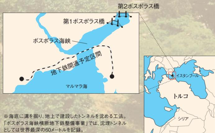
※海底に溝を掘り、地上で建設したトンネルを沈める工法。「ボスボラス海峡横断地下鉄整備事業」では、沈埋トンネルとしては世界最深の60メートルを記録。
