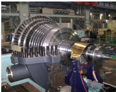
蒸気の圧力や量などラヘンドン地域の地熱資源の特性に合わせて設計されたタービン。日本の技術の結晶だ
