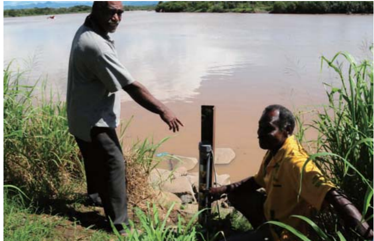
ナワンガルア村近くの川に設置された水位計を指差すブニシナ村長。川に一番近い家までケーブルがつながり、危険水位になるとサイレンが鳴る
