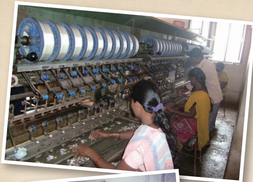
JICAの支援で開発された二酸化性生糸を繰り取る多糸機（上写真）と従来機（下写真）を比べて品質向上した
