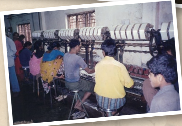
JICAの支援で開発された二酸化性生糸を繰り取る多糸機（上写真）と従来機（下写真）を比べて品質向上した
