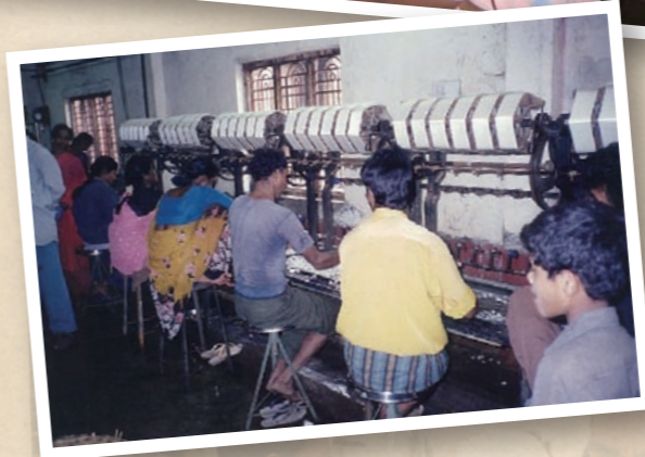
JICAの支援で開発された二酸化性生糸を繰り取る多糸機（上写真）と従来機（下写真）を比較して品質向上を図った。
