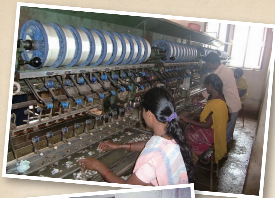
JICAの支援で開発された二酸化性生糸を繰り取る多糸機（上写真）と従来機（下写真）を比較して品質向上を図った。
