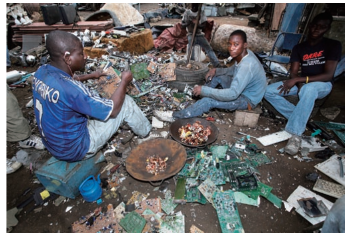
ケーブルを燃やして銅線を取り出すときに有害ガスが出るという
