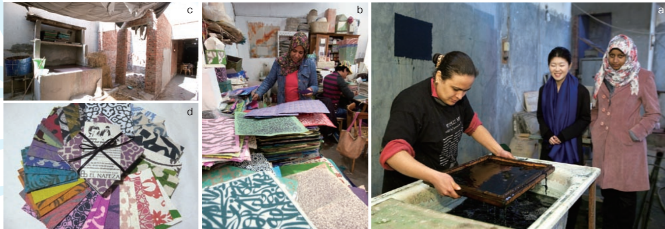
a.日本とエジプトの紙すき技術を組み合わせ、すいた紙を壁に貼り付けて天日干しをする b.さまざまな柄や色がある手すき紙。これを利用した商品は30種類以上にも及ぶ c.ワラを水につけて、煮るための作業場。ここで紙の原料へと生まれ変わる d.高橋さんのアイデアから生まれた色とりどりのカットペーパー
