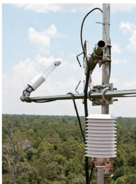
熱帯泥炭湿地林、泥炭火災跡地、農地開発跡地に観測タワーを設置し、頂上に取り付けた機材で二酸化炭素排出量を計測している
