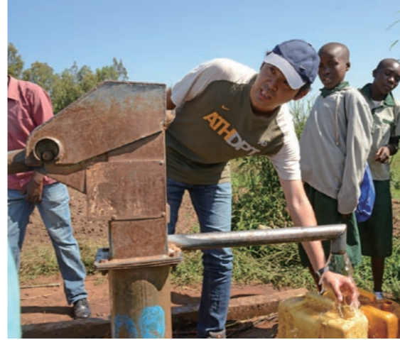
小学校でハンドポンプの修理方法を指導する櫻井さん。子どもが体重をかけてポンプを押すと、負荷がかかって壊れやすくなってしまふ
