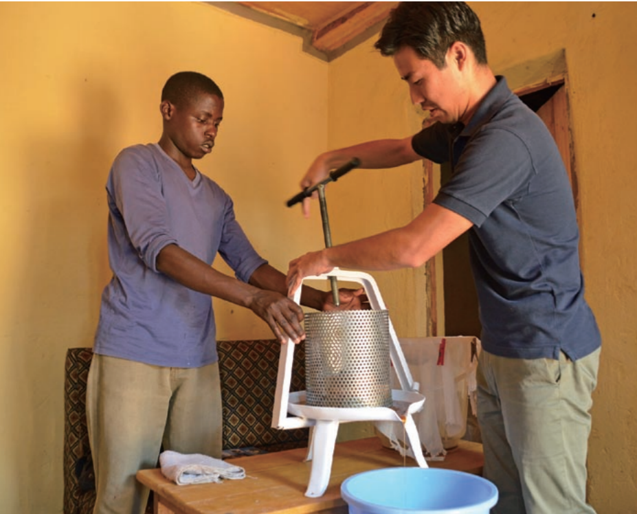
ハチの巣をアルミの容器に入れて、専用の機械で上から押しはちみつを絞る。コツがあるがジョセフさん(左)の手にかかれればお手のもの
