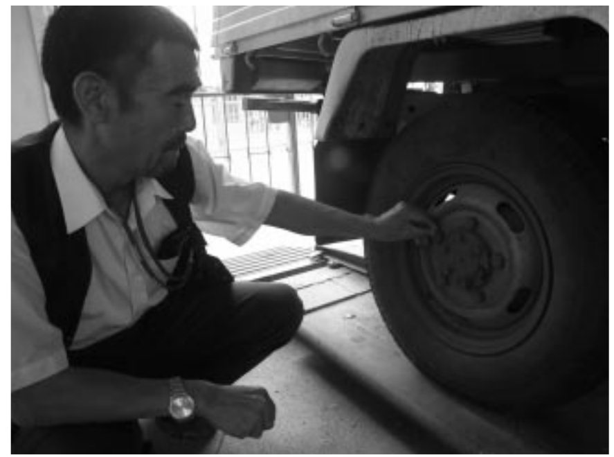
タイヤを留めるネジもただ強く締めるのではなく、その加減が大事なのだと言っている稲見さんは語る
