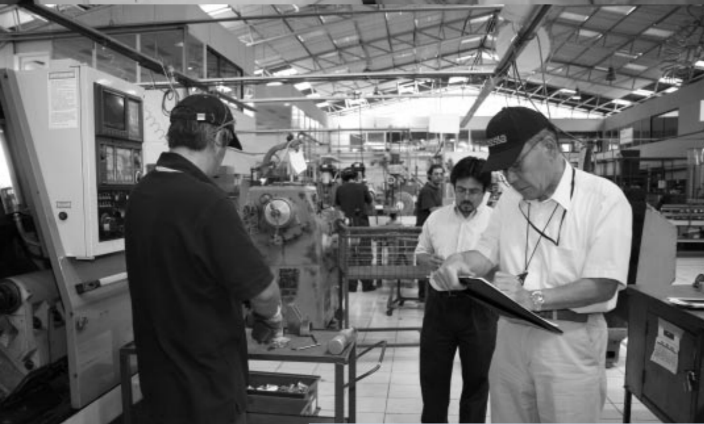
機械の位置を新しく変えた後、働き具合をチェック。後ろの現場監督は従業員のすべての動きを線で描き、各所にかかる時間を記入。これをもとに無駄な動きを会議で話し合う
