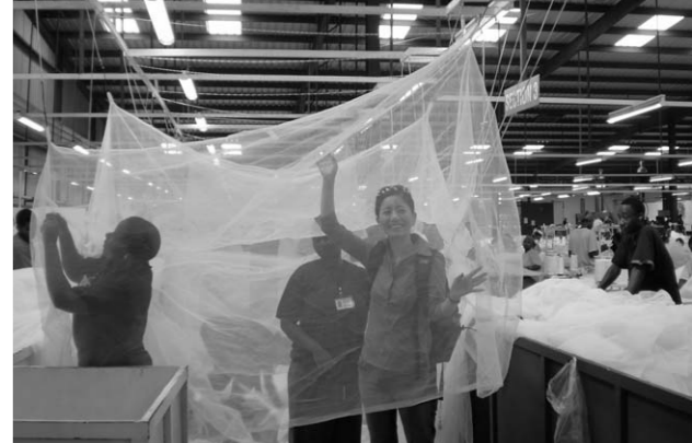
完成したばかりの「オリセット® ネット」に入る草野さん。現地の工場では、樹脂から作った糸をより合わせ、編み機で大きなシートを編んでから裁断し、立体的に縫い合わせて蚊帳を完成させる。その後、実際に中に入って点検し、品質を確認してから包装する
