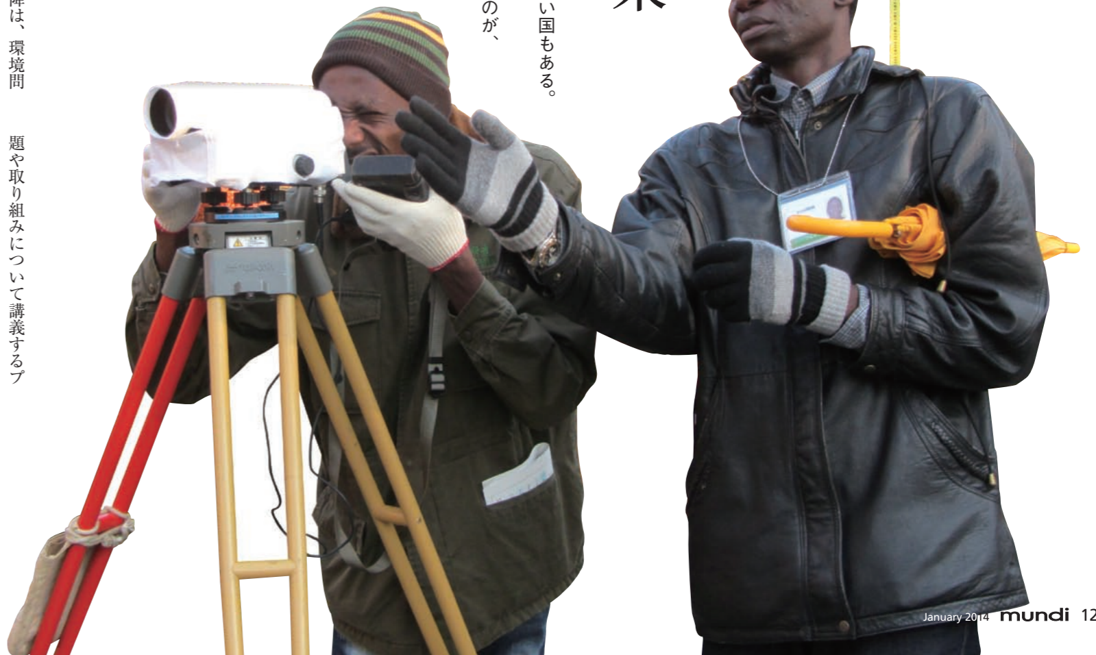
研修の一環として、前方にあるものさしを見ながら測量を行う研修員
