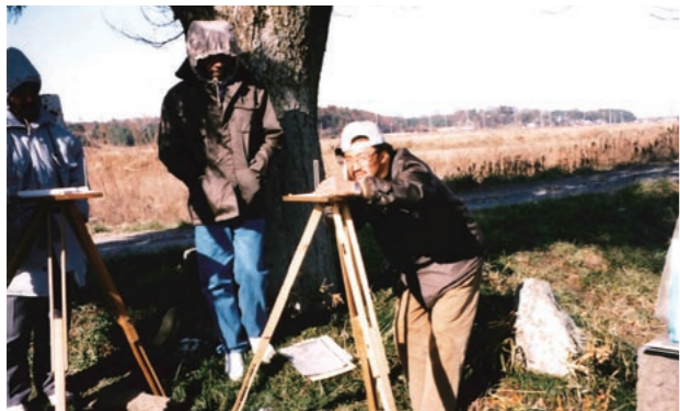
図版の上で、定規や方位磁石などを使って測量。90年代に研修で教えていた技術だ
