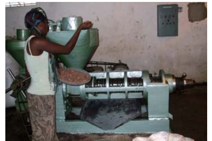
機械を使ってバオバブの種からオイルを抽出。ジュース工場でも処分されていた種も有効活用されている
